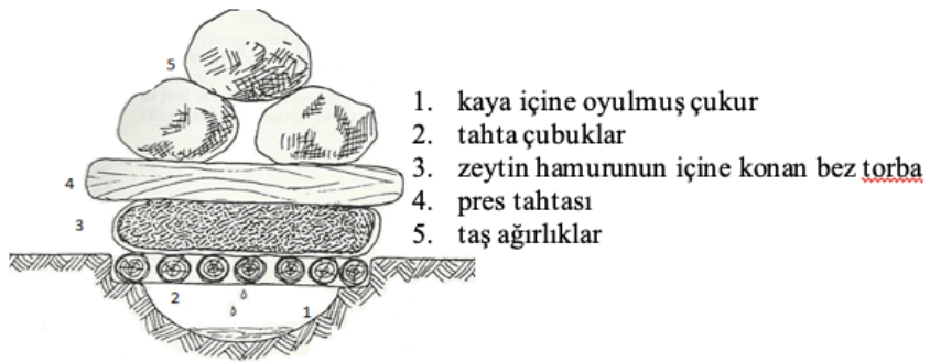
Resim 12: İlk sıkma yöntemi
