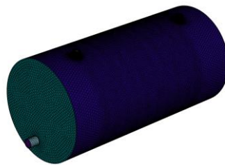
Şekil 3. Helisel borulu ısı değiştirici modelin ağ yapısı
