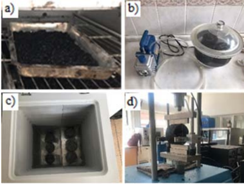
Şekil 5. ASTM D4867 deney prosedürü aşamaları; a) Yaşlandırma, b) Suya doygun hale getirme, c) Dondurma, d) Dolaylı çekme deneyi (ASTM D4867 experiment procedure a) Aging b) Saturation c) Freezing d) ITS test)
