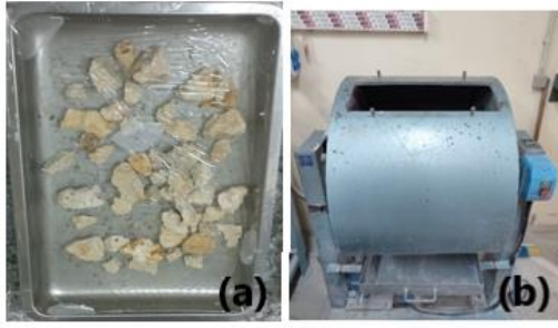
Şekil 3. Laboratuvar deneyleri a) su emme deneyi b) Los Angeles aşınma deneyi
