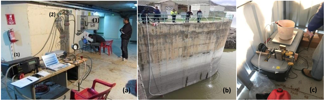
Şekil 2.(a) (1)Florometre, DAQ, Veri kayıt bilgisayarı, (2)Giriş basınç ve fark basınç sensörleri, (3)VİS panosu, (b) Cebri boru girişinde boya enjeksiyonu, (c) Boya enjeksiyon düzeneği
