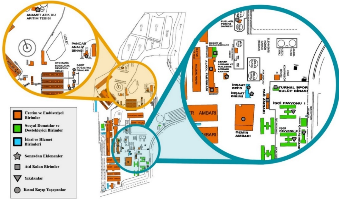
Şekil 6. Fabrika üretim tesislerinin fonksiyon ve kullanım şeması (Turhal Şeker Fabrikası arşivinden işlenerek yazar tarafından üretilmiştir, 2025) 5 .
