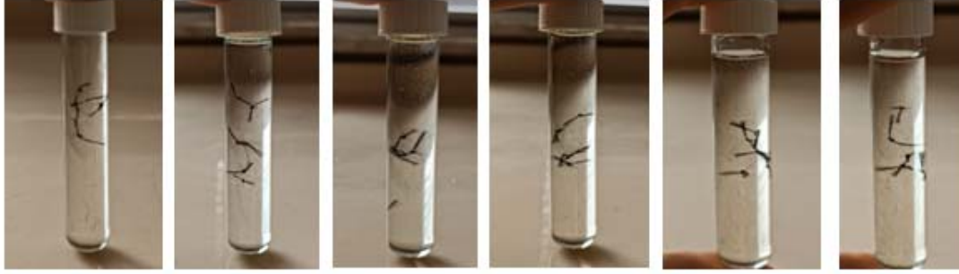
Şekil 3. GK modifikasyonu sonrası termal olarak stabilize edilen numunelerin yoğunluk değerlerinin belirlenmesi için hazırlanan yoğunluk sıvıları (Density fluids prepared for determining the density values of thermally stabilized samples after GC modification)
