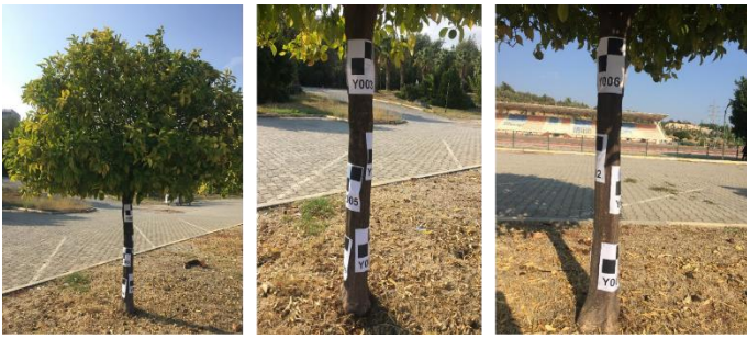
Şekil 3. Ağaç üzerinde referans hedef kağıtları gösterimi
