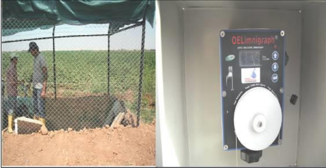
Şekil 3. Kontrol yapısı üzerine inşa edilen dikenli tel (a) ve su düzeyi kaydedicisi (b)
