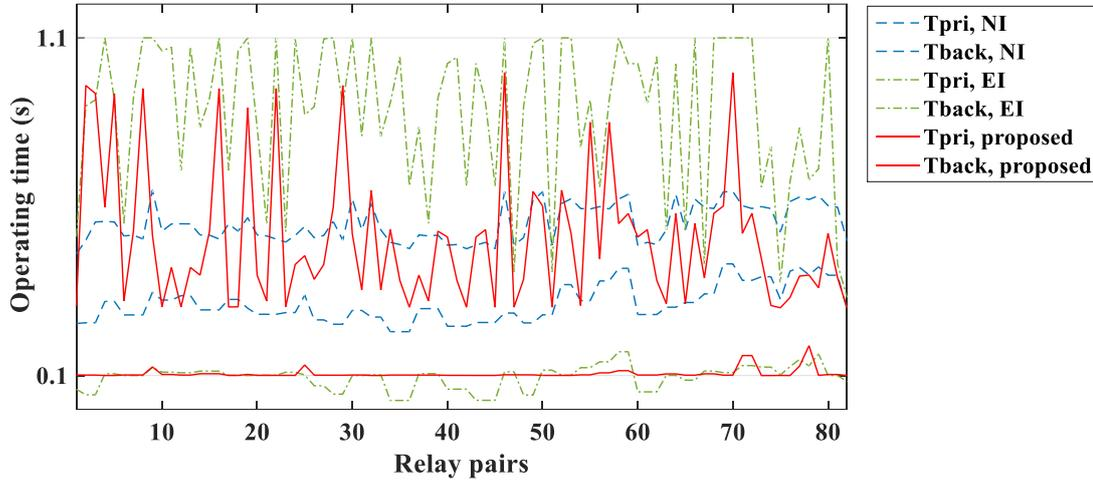
**Figure 6.** Operating times corresponding to the optimal relay settings obtained using the NOA for the IEEE 15-bus system (IEEE 15-baralı sistem için NOA kullanılarak elde edilen optimal röle ayarlarına karşılık gelen röle işlem süreleri)
