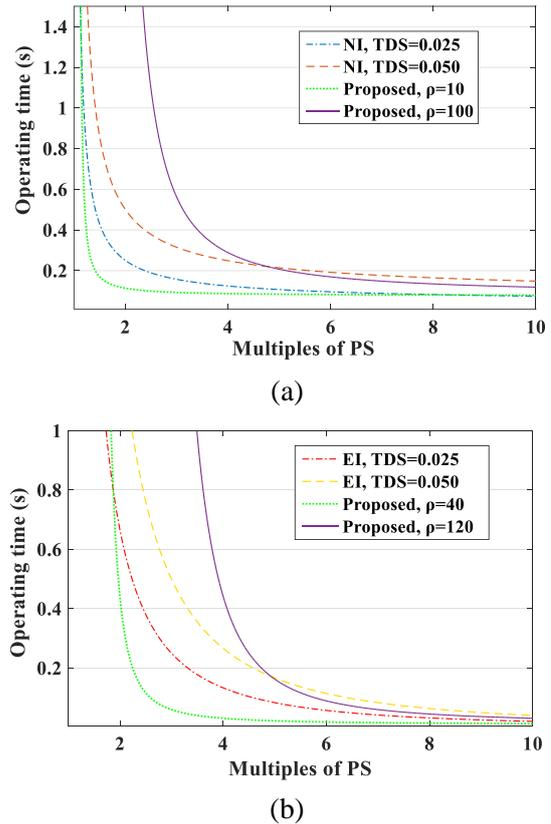
**Figure 1.** Comparison of the (a) NI-proposed and (b) EI-proposed relay characteristics ((a) NI-önerilen ve (b) EI-önerilen röle karakteristiklerinin karşılaştırılması)
