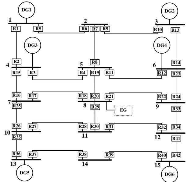
**Figure 5.** Single-line diagram of the IEEE 15-bus test system (IEEE 15-baralı test sistemi tek hat şeması)
