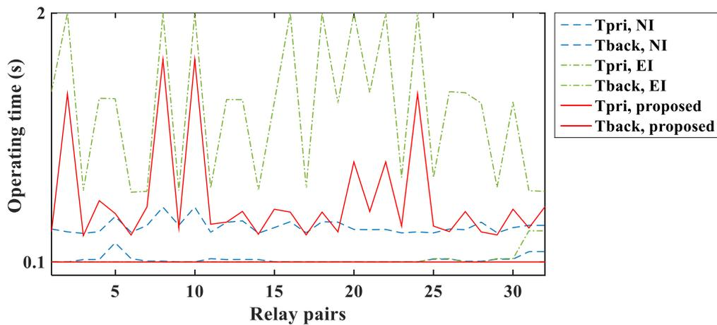
**Figure 3.** Operating times corresponding to the optimal relay settings obtained using the NOA for the IEEE 9-bus system (IEEE 9-baralı sistem için NOA kullanılarak elde edilen optimal röle ayarlarına karşılık gelen röle işlem süreleri)
