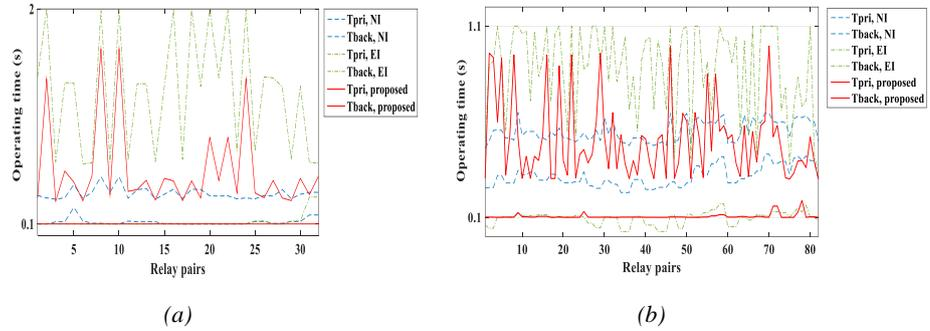
**Figure A:** Primary and backup relay operating times obtained via NOA algorithm for a) IEEE 9-bus and b) IEEE 15-bus systems / **Şekil A:** NOA algoritmasıyla elde edilen a) IEEE 9-baralı ve b) IEEE 15-baralı sistemler için birincil ve yedek röle çalışma süreleri
