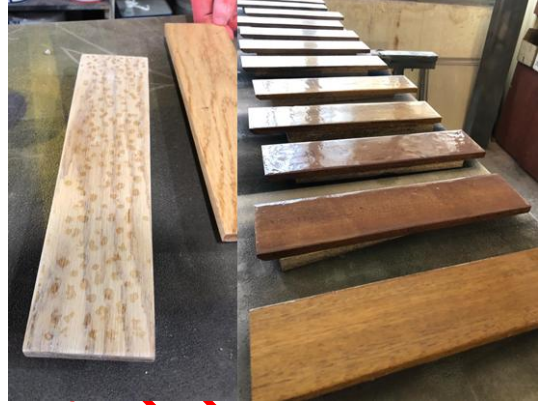
Şekil 1. Hazırlanan örneklerin epoksi ve zımpara işlemleri / Figure 1. Epoxy and sanding processes of the prepared samples
