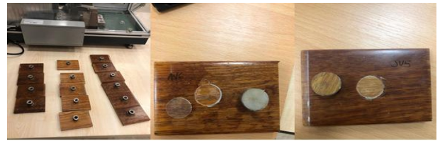
Şekil 2. Yüzeğe yapışma işlemi öncesi ve sonrası deney örnekleri / Figure 2. Experimental samples before and after surface adhesion treatment
