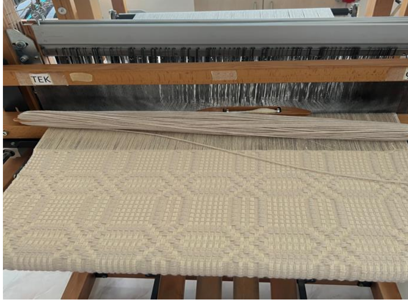
Görsel 1. Sedefli Battaniye Dokuma Aşaması, Fotoğraf: Gizem Çolpan, 2024, Balıkesir.
