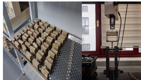
Resim 3. Levha yüzeyine dik vida çekmede kullanılan deney örnekleri ve kalıp (Test samples and molds used in pulling screws perpendicular to the plate surface)
