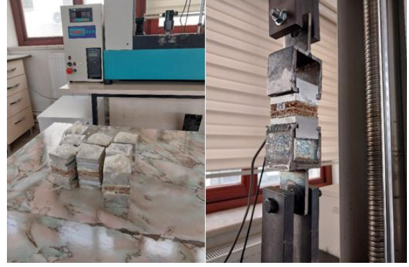
Resim 2. Deney örneklerinin universal test cihazındaki durumu (Condition of test samples in universal testing machine)
