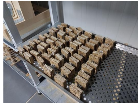
Resim 1. Farklı yoğunluk ve yün karışımı numuneler (Samples with different density and wool blends)
