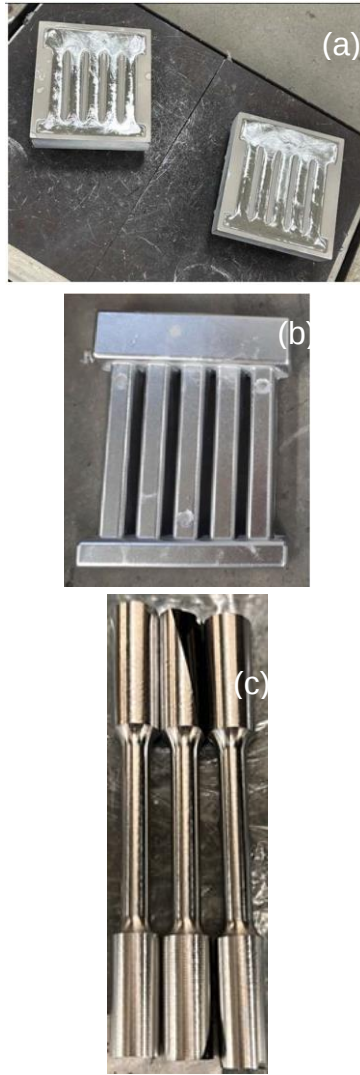
Şekil 3. (a) Kalıp içinde, (b) Kalıp dışında, (b) Talaşlı işlenmiş örnek döküm numuneleri (Figure 3.(a) In the mold, (b) Outside the mold, (c) Machined sample casting specimens)
