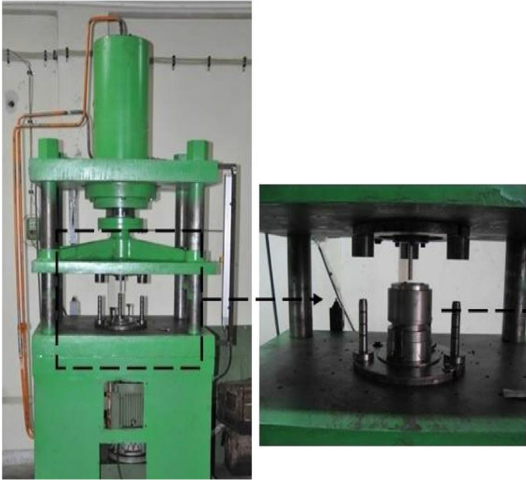
Şekil 3. Ekstrüzyon işleminde kullanılan hidrolik pres.
