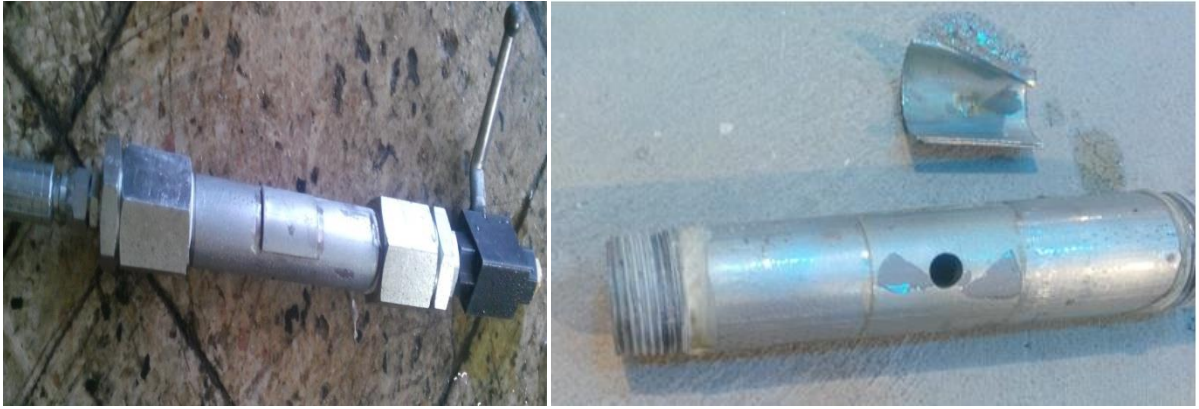
Şekil 6. Deney düzeneği a) tamir edilmiş b) hasara uğramış
