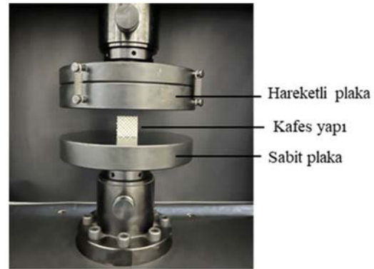
Şekil 7. Test cihazı ve kafes yapı yerleşimi (Test device and location of lattice structure)
