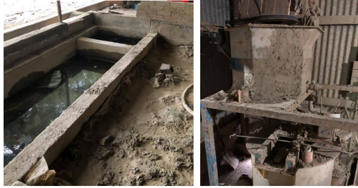
Görsel 3. (Solda) Kil Havuzları ,2019. Kişisel Arşiv. (Sağda) Havuzdan Gelen Kilin Süzüldüğü Kazan, 2019. Kişisel Arşiv.
