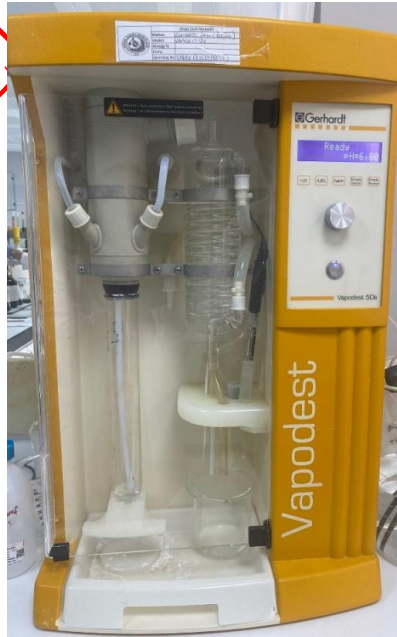
Şekil 3. Destilasyon ünitesi (Distillation unit)
