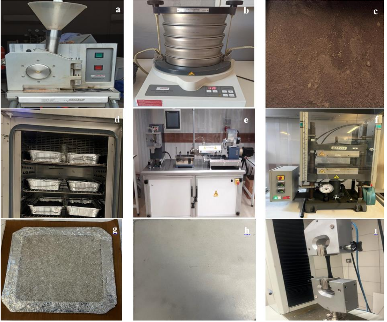
Şekil 1. Biyokompozit levhaların hazırlık, basım ve test süreçlerine ait görseller a. Öğütme b. Eleme c. Eleme sonucu hammadde d. Kurutma e. Ekstrüder f. Sıcak pres g. Kalıplama h. Levha i. Test
