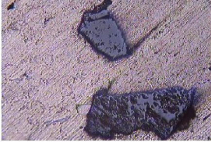
Şekil 6. Al 2014-% 10 SiC 620 C kompozitinin anametal mikroyapı fotoğrafı (x200)
