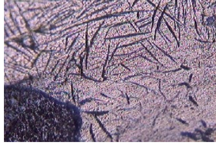
Şekil 9. Al 2014-%20 SiC 600 °C kompozitinin kaynak metal mikroyapı fotoğrafı (x200)
