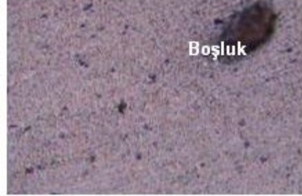
Şekil 5. Al 2014-%0 SiC 620 C kompozitinin kaynak metal mikroyapı fotoğrafı (x400)
