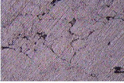
Şekil 4. Al 2014-%0 SiC 620 C kompozitinin ana metal mikroyapı fotoğrafı (x200)
