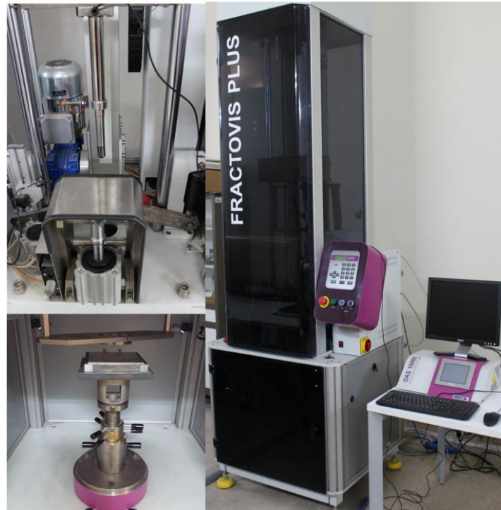
Şekil 2. Düşük hızlı darbe test cihazı
