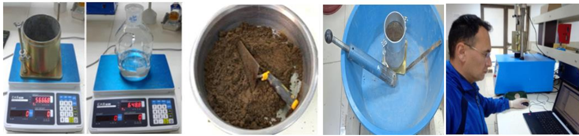
Şekil 3. CBR deneyinin hazırlanması, yükleme ve veri okuma aşamaları
