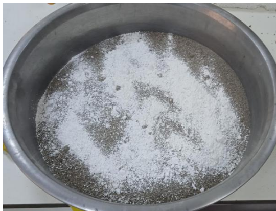
Şekil 2. Kumlu zemin ve öğütülmüş pomza taşı numunesinin görünüşü
