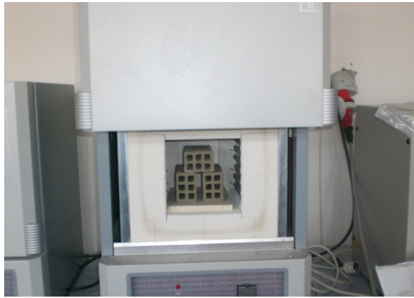
Şekil 2. Yüksek sıcaklıkta pişirilen 3 adet tuğla numunesi
