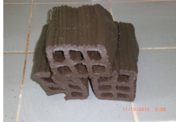
Şekil 12. 1200 °C’ de pişen tuğla örnekleri
