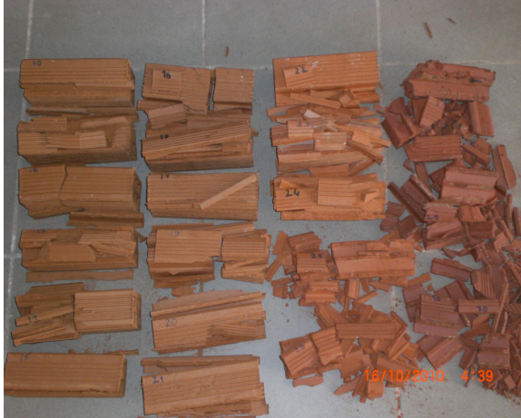
Şekil 11. 500-1100 °C arasında pişen tuğlaların dayanım testinden sonraki görüntüleri
