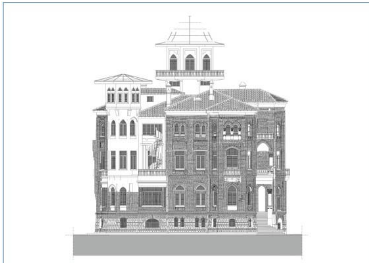
Görsel 14: Kuzeydoğu cephesi genel görünüm, sıvalı kule yapısı ve tuğla cephe
