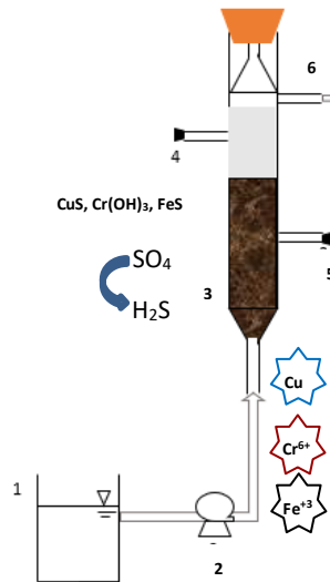
Şekil 1. Lab ölçekli Sülfat-İndirgeyen Sabit Aktif Karbon Yataklı Biyoreaktör (Sİ-AKYB) Sistemi (1. Atıksu besleme tankı, 2. Atıksu besleme pompası, 3. Sabit sülfat indirgeyen aktif karbon yataklı biyoreaktör, 4., 5. Numune alma portları, 6. Biyoreaktör çıkışı)
