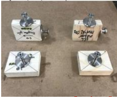
Şekil 3. Yüzeylere dik yönde vida çekme test örnekleri (Screw withdrawal strength test in tangential and radial directions) [24].
