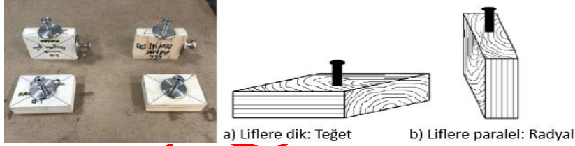
Şekil 3. Teğet ve radyal yönde vida çekme direnci testi. (Screw withdrawal strength test in tangential and radial directions).
