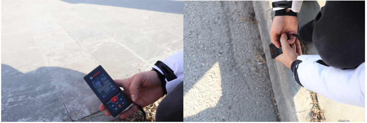
Şekil 3. Kaldırım uzunluk ve genişliklerinin tespit edilmesi
