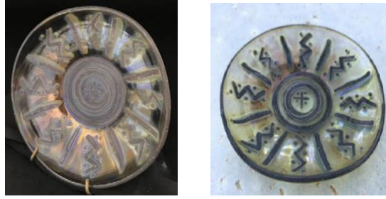
Görsel 9. 7 Nolu macun lüsteri reçetesinin yumuşama derecesinin üzerindeki sıcaklıklarda camın deformasyonu ve macunun cam yüzeye gömülmesi.
