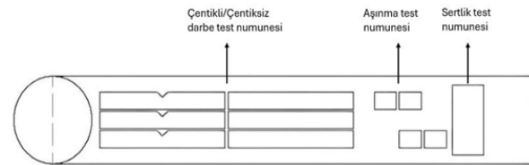
Şekil 1. Polimer malzemelerden alınan test numuneleri (Test specimens from the polymer materials)
