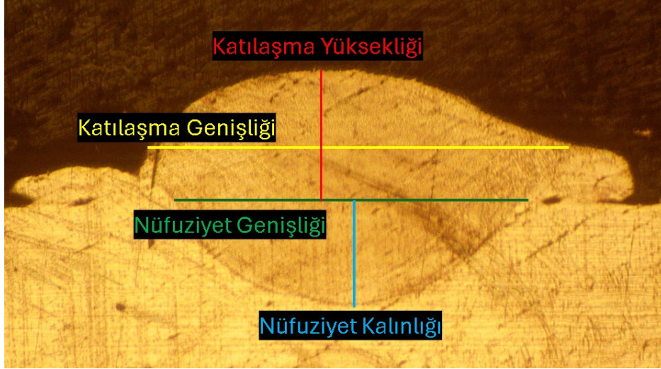
Şekil 4. Ergime bölgesine ait ölçümü yapılan geometrilerin gösterimi
