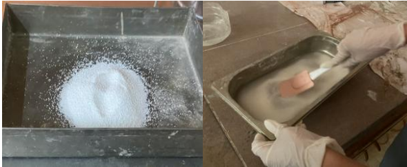
Şekil 3. Deneyde kullanılan granül haldeki katı sodyum metasilikat ve su içinde çözülmesi (The granule form solid sodium metasilicate and mixed with water)
