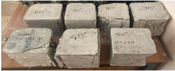
Şekil 6. Farklı sıcaklıklarda 24 saat boyunca kürlenmiş ve 7. gün (erken yaş basınç dayanımı) basınç dayanımına tabi tutulan geopolimer beton numunelerinin deney sonrası durumu (Geopolymer concrete samples cured at different temperatures for 24 hours and subjected to compressive strength testing on the 7th day (early strength))
