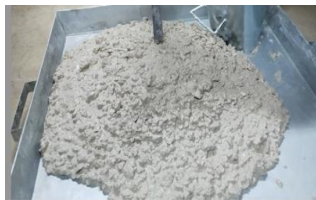
Şekil 4. Tek bileşenli taze geopolimer beton karışımının son hali/ Final state of the one-part fresh geopolimer concrete mixture
