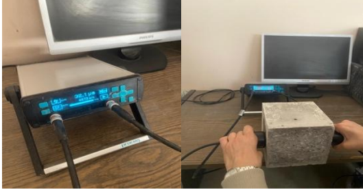
Şekil 5. UPV test cihazı ve tek bileşenli geopolimer beton numunelerinin UPV testine tabi tutulması (UPV apparatus and UPV test results of one-part mixing geopolymer concrete samples)
