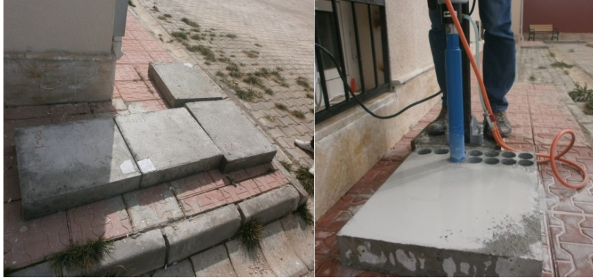
Şekil 3: Karot örneklerinin plak betonlardan alınması
