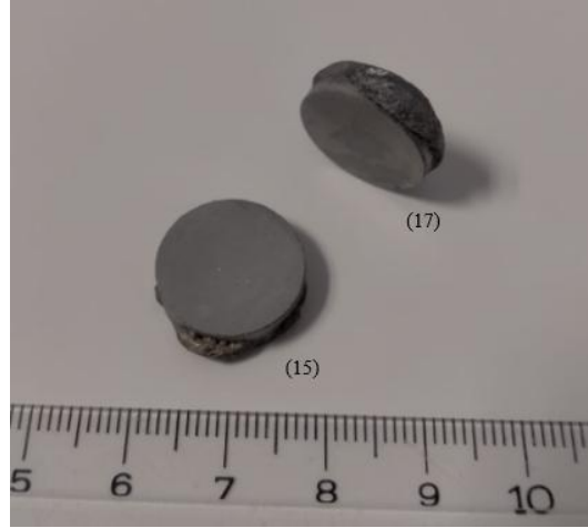
Şekil 7. 700 °C’de sinterlenen ve kısmi olarak ergiyen bazı numuneler
