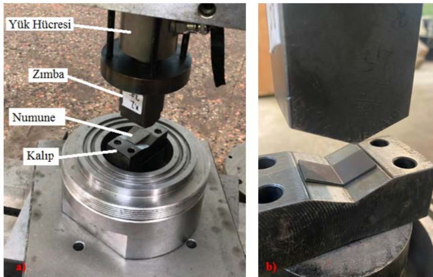
Şekil 5. Deneysel çalışma ortamı ve deney düzeneği kalıpları (Experimental work environment and experimental setup)
