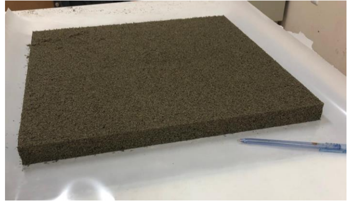
Şekil 2. Soğuk preslemeden sonra kalıptan çıkarılmış levha taslağı.
