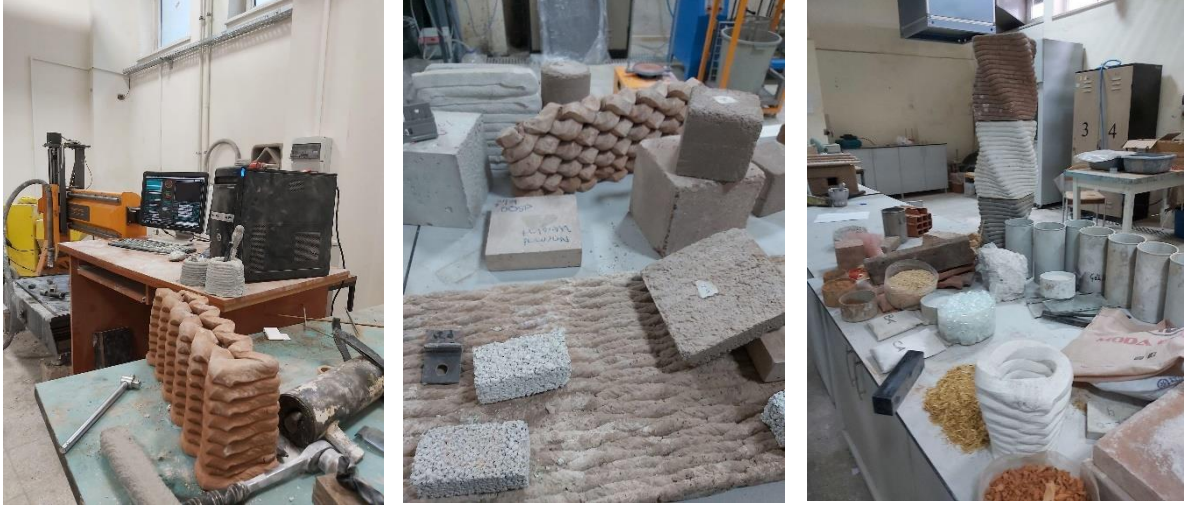
Şekil 1. Hacettepe Üniversitesi İnşaat Mühendisliği Bölümü İleri Yapı Malzemeleri Araştırma Laboratuvarında 3D beton baskı görüntüleri (Yazarın kişisel arşivi, 2024).
