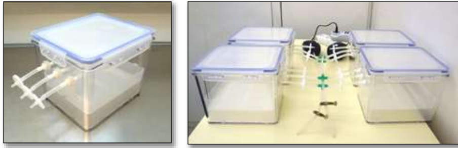
Figure 1. PlantForm Temporary Immersion System (Anonymous, 2024) Şekil 1. PlantForm Geçici Daldırma Sistemi (Anonim, 2024)
