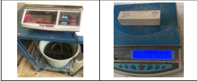
Şekil 3. Karo atıklı geopolimer harç numunelerinin su emme, porozite ve yoğunluğunun belirlenmesi.
