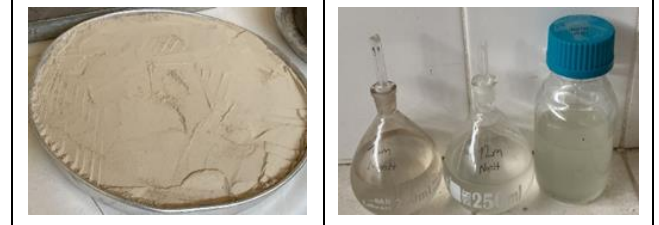
Şekil 1. Geopolimer harç yapımında kullanılan öğütülmüş, elenmiş etüv kurusu haline getirilmiş karo atığı ve 10M, 12M ve 14 M, 225 g NaOH çözeltileri.
