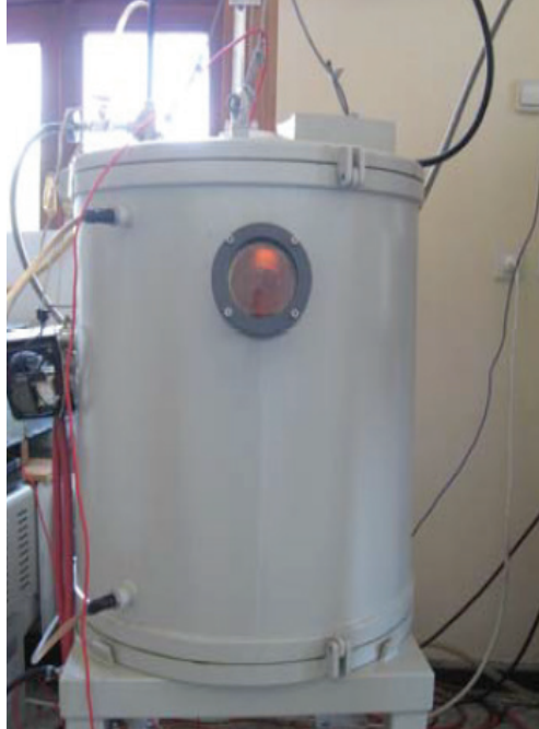
Şekil 2. Plazma borlama deney odası
