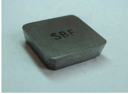
Şekil 1. BÖHLER SPKN 1203 ED-R tungsten karbür kesici uç
