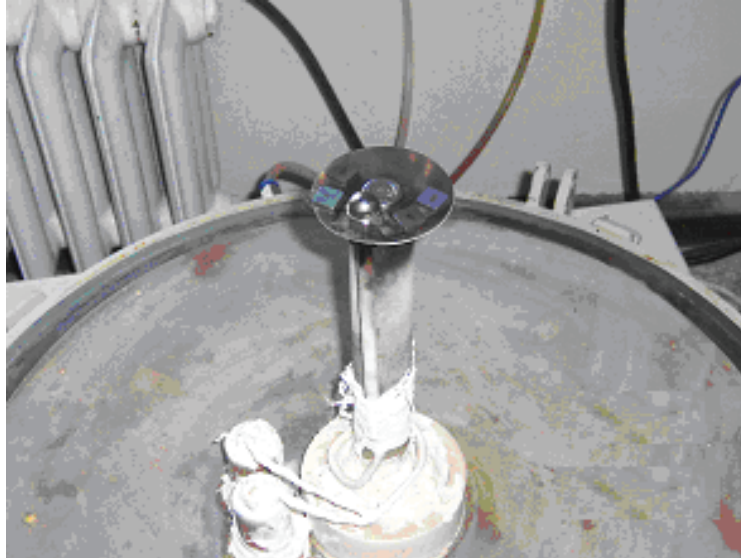
Şekil 4. Kesici uçların deney odasına yerleştirilmesi
