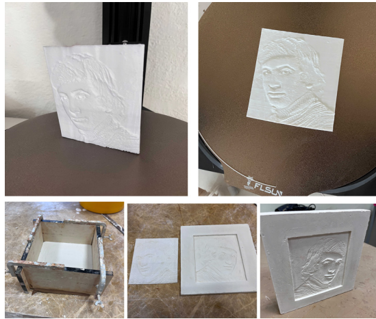
Görsel 12. Üç boyutlu yazıcıdan çıkan portre modelinin alçı kalıp aşaması
