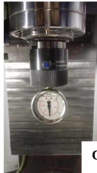
Şekil 1. Statik Ölçümler: A- Konik içi salgı ölçümü B- 300 mm test bar salgı ölçümü C- Takım çekme kuvveti ölçümü, Dinamik Ölçümler: D- Spindle eksenleri balans ve rulman sağlığı ölçümü
