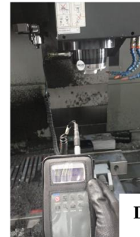
Şekil 1. Statik Ölçümler: A- Konik içi salgı ölçümü B- 300 mm test bar salgı ölçümü C- Takım çekme kuvveti ölçümü, Dinamik Ölçümler: D- Spindle eksenleri balans ve rulman sağlığı ölçümü
