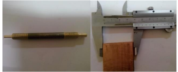
Şekil 7. Pirinç katot ve bakır anot
