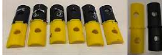
Şekil 4. Çekme testi için hazırlanan numuneler
