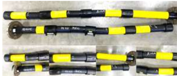
Şekil 7. İç basınç testi için kör tapa takılmış numuneler
