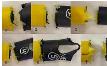
Şekil 8. Çekme test sonuçlarının detaylı gösterimi. a) Deney 1, b) Deney 2, c) Deney 3, d) Deney 4, e) Deney 5, f) Deney 6
