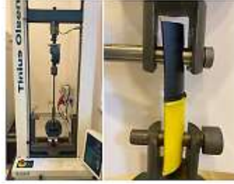
Şekil 5. Çekme test cihazı ve çene bağlantı düzeneği
