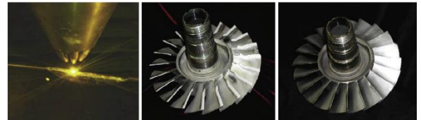
Şekil 5. Önce katmanlı imalatla hasarlı kısmının doldurulduğu, sonra CNC işlemle son haline getirildiği bir helikopter pervanesi [15].
