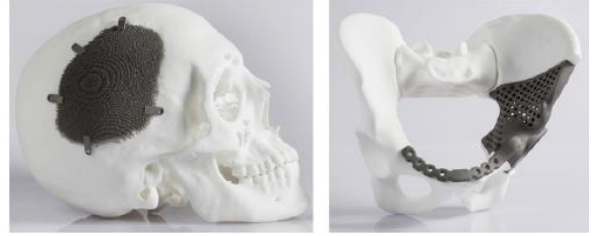
Şekil 1. Medikal sanayiinde kullanılan ve katmanlı imalatla üretilen Titanyum implantlar [8].
