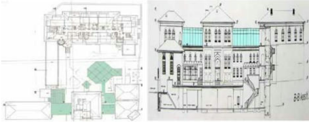
Görsel 12: Avluya eklenen restoran yapısı ve tüp geçit eki
