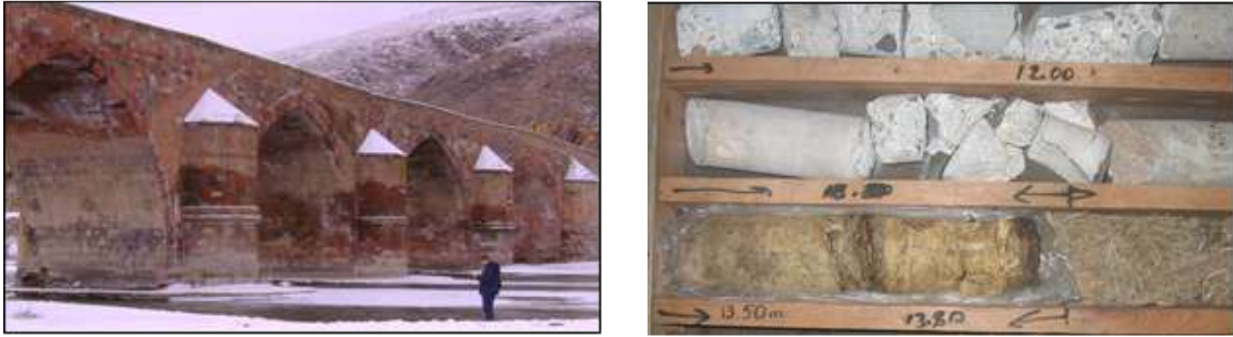
Şekil 6. Tarihi Çobandede Köprüsü (Erzurum) karot numuneleri sandığı ( Sert vd., 2009 )
