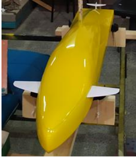
Şekil 7. Modelin su altı deneylerinden hemen önce, alt gövde ve üst kapak birleştirilmiş durumu.
