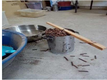
Şekil 9. Pelet yığın yoğunluğunu belirleme işlemi
