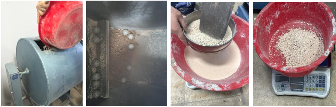
Şekil 10. Agregaların Tambura Konulması, Sonrasında Elenmesi ve Ağırlıklarının Ölçülmesi
