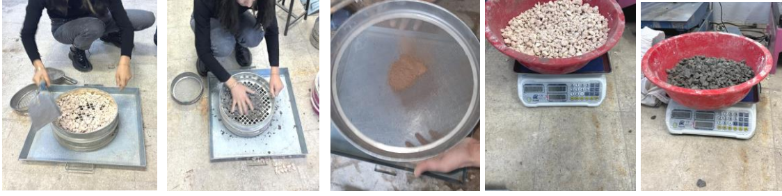
Şekil 9. Agregaların Elekten Geçirilmesi Agregaların Ağırlıklarının Ölçülmesi
