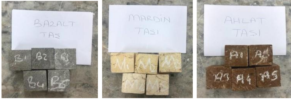
Şekil 7. Tek Eksenli Yük Altında Basınç Deneyinde Kullanılan Numuneler
