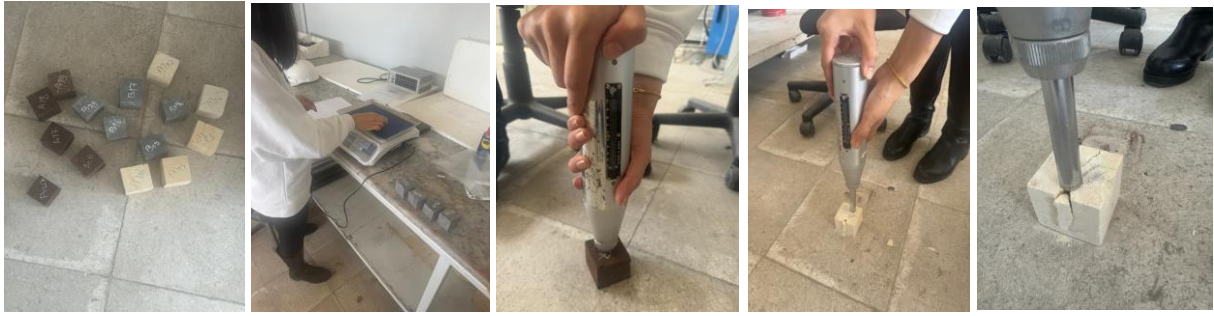
Şekil 11. Schmidt Çekici Deneyinde Kullanılan Numuneler ile Schmidt Çekici Deneyi Uygulanması
