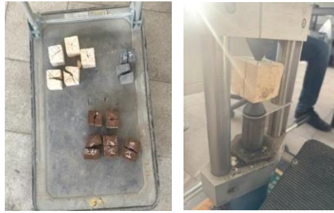
Şekil 6. Nokta Yük Dayanım Deney Sonrası Numunelerin Durumları
