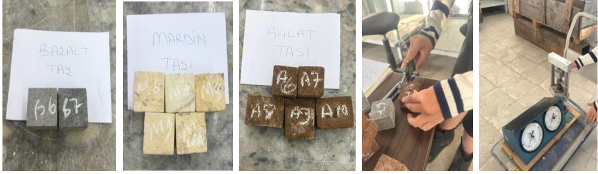
Şekil 5. Nokta Yük Dayanım Deneyinde Kullanılan Numuneler ve Deney Düzenine Yerleştirilmesi
