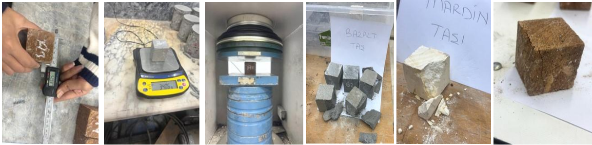
Şekil 8. Numunelerin Tek Eksenli Basınç Deneyi Öncesi ve Sonrası Durumu
